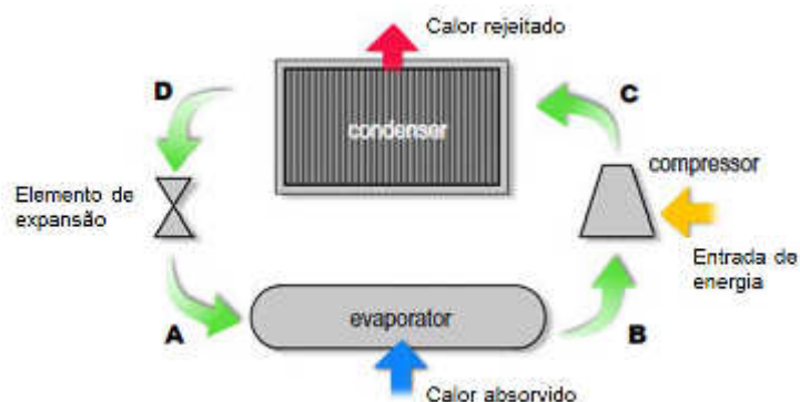
Figura 2-7 – Componentes principais do ciclo de compressão a vapor
