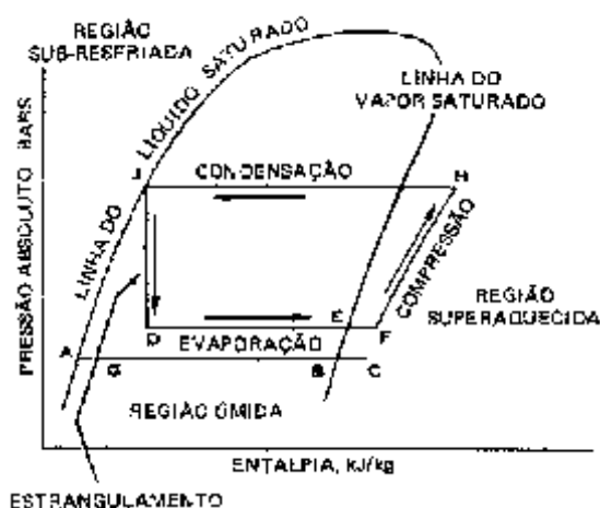
Figura 2-9 - Diagrama de Mollier ou P x h
